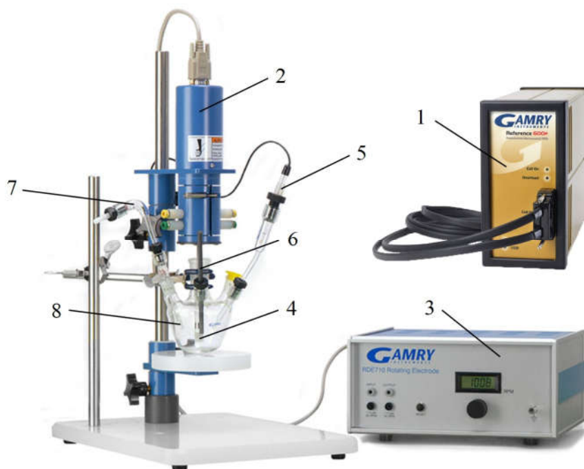
图 1-3 基于旋转电极法的三电极电化学测试装置
