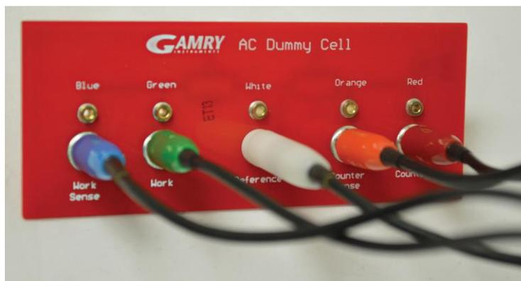
图 1-8 虚拟电路的线路板同电化学工作站的连接方式
